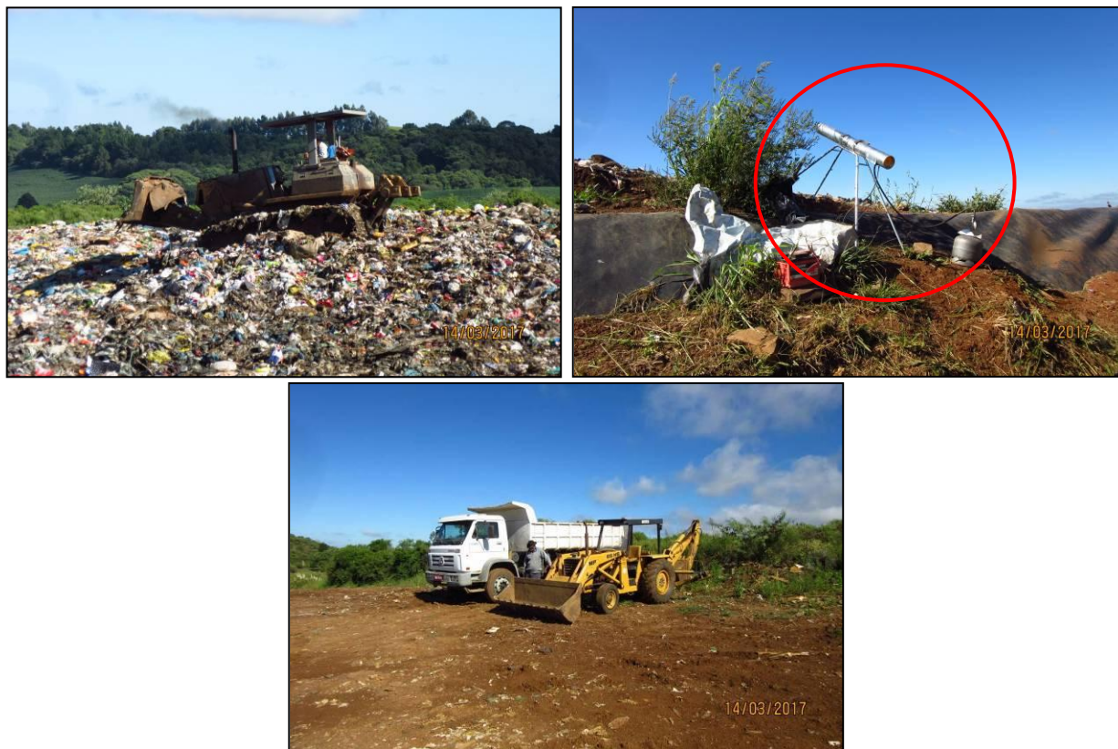
Fotos 4.19, 4.20 e 4.21 – Trator de esteira e equipamento espanta pássaros. Caminhão caçamba e retroescavadeira utilizados como equipamentos de apoio na operação do aterro sanitário.
