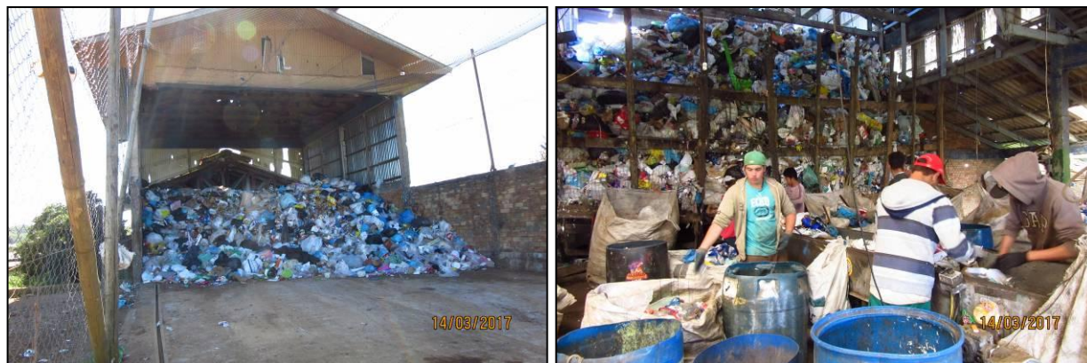
Fotos 4.24 e 4.25 – Plataforma de descarga da coleta seletiva e esteira de catação.
