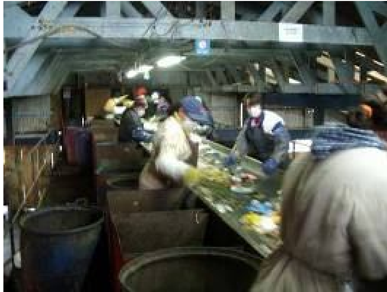
Figura 19 – Separação de resíduos na Usina de Triagem
